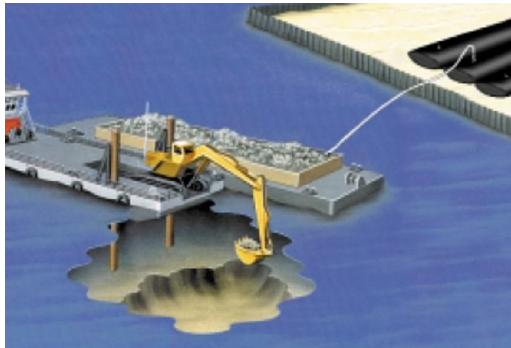
1 - баржа с сапропелем, 2 - кран для выгрузки сапропеля на осад, 3 - контейнер обезвоживания сапропеля, 4 - отвод возвратной воды после обезвоживания в водоем, 5 - ровная площадка под укладку контейнеров обезвоживания geotube
